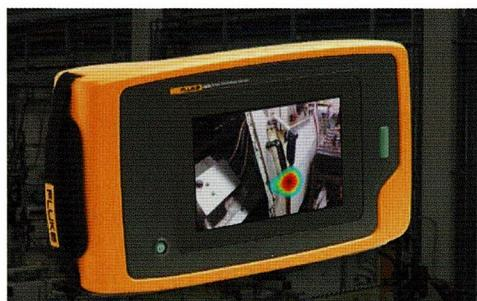
エア漏れの音を可視化する特殊カメラを使用してお客様の工場内を巡回し、エア漏れ診断を行います。
